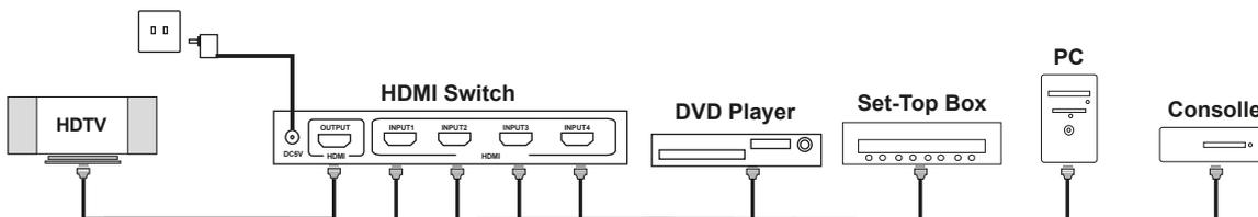
**Note :** quando lo switch HDMI è in funzione, prestare attenzione che tutti i dispositivi siano connessi via cavo. Per far sì che il dispositivo lavori correttamente, accendere anticipatamente lo switch ed in seguito, accendere i dispositivi sorgente.
